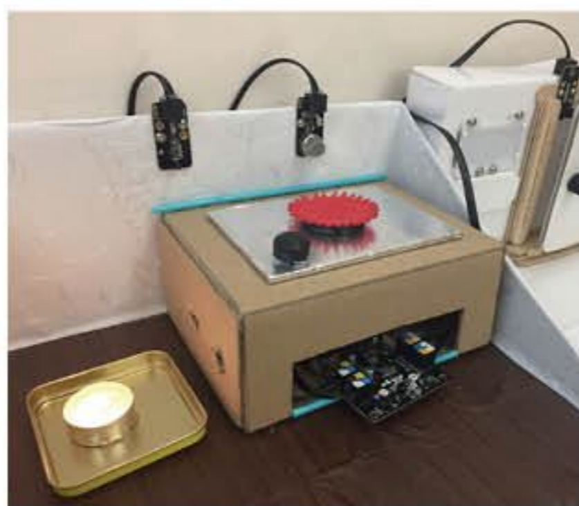
▼ 火警偵測裝置 - 火焰傳感器偵測到有火種後，旁邊的LED面板會顯示火焰形狀，並發出聲音提醒長者。
