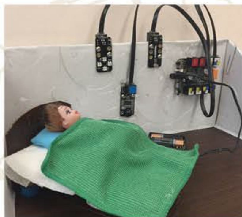
▼ 智能照明設備 - 人體紅外傳感器偵測到長者起床後，LED模塊會逐漸變亮。
